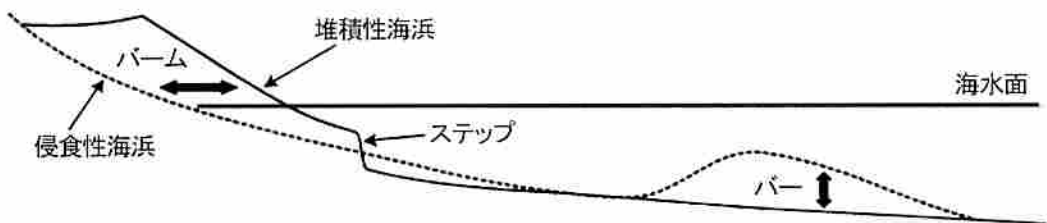
図1. 堆積性と侵食性の海浜プロファイル。
