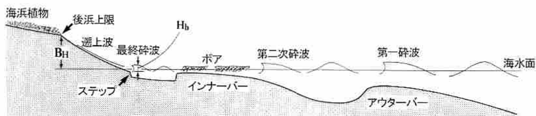
図4. インナー・バーが発達する海岸における波の変化過程。
